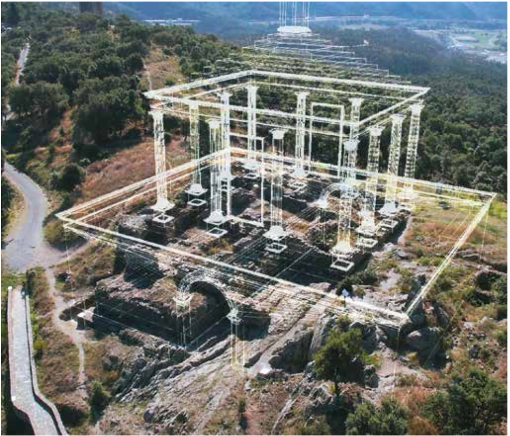
Figure 14 – Restitution du Trophée de Pompée au col de Panissars dans les Pyrénées, daté de 71 avant J.-C. Cet imposant monument a été établi à la limite de la Gaule et de l’Hispanie. Une galerie aménagée dans le massif de l’édifice à deux niveaux permet le passage de la voie.
